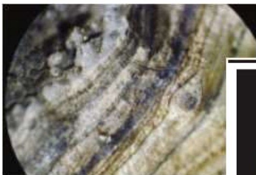
Struvit (fosfat de amoniu si magneziu) in combinatie cu depunerile de namol /polimer
